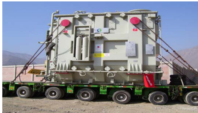
Vista del traslado de un transformador monofásico de potencia a la Subestación de Carabayllo: 200 MVA , 500/220 kV
