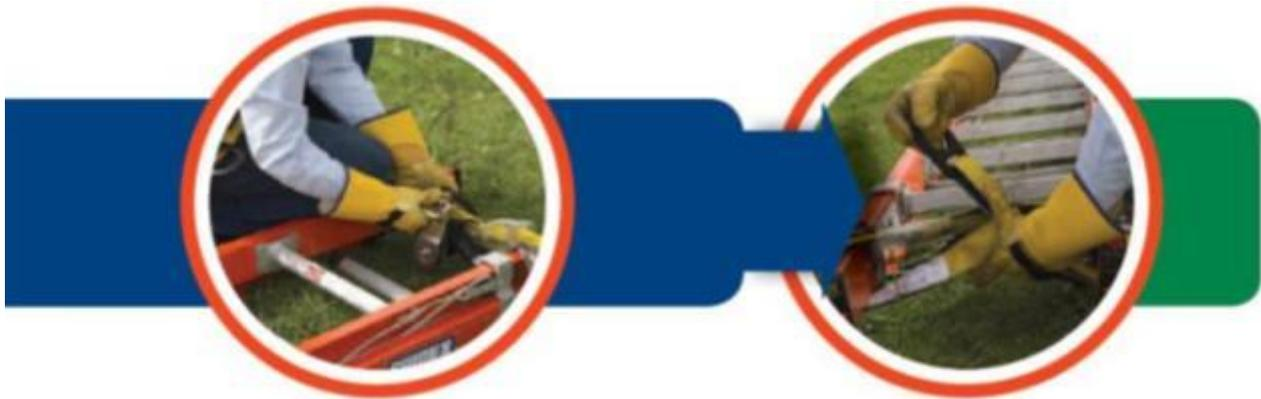
Pase la punta o cabo de la cuerda estática (línea de vida), a través de la polea; lleve este extremo de la cuerda, por el frente de la escalera y amárrela al primer peldaño inferior, utilizando un nudo ballestrinque.
